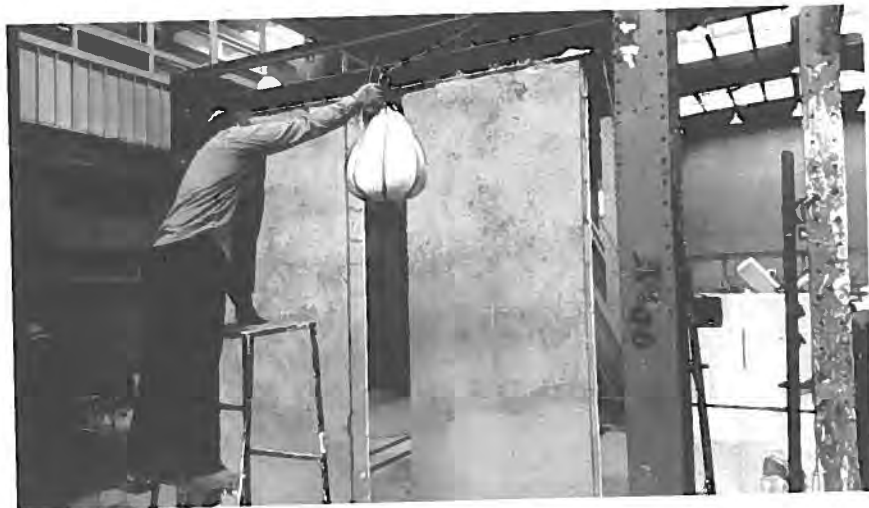
شکل (۵-۱) آزمایش ضربه جسم نرم سنگین
